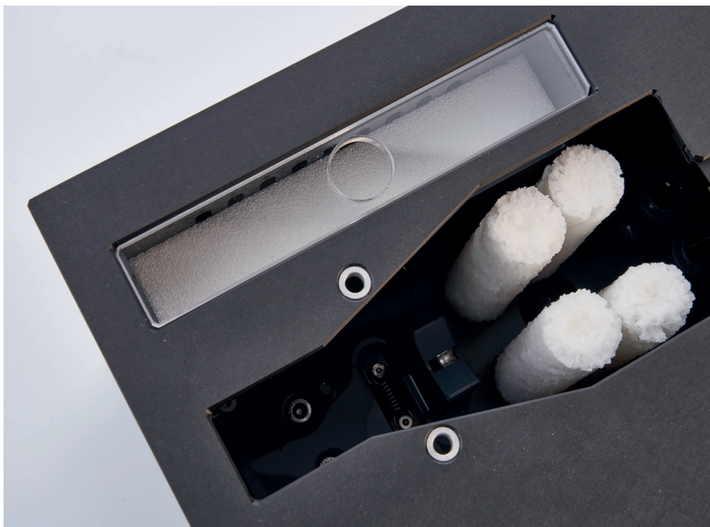
Die beiden Walzen auf einer Seite der Platte drehen sich gegenläufig. Der Filter für die Flüssigkeit wird mit einer Plexiglas-Scheibe abgedeckt
