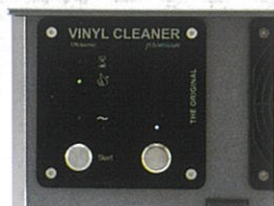
スイッチは電源用とスタート/コントロール用の2個とシンプル。運転状況はランプで表示される
